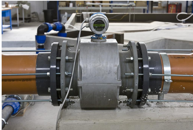
Figura 2.4 – Misuratore magnetico di portata.
