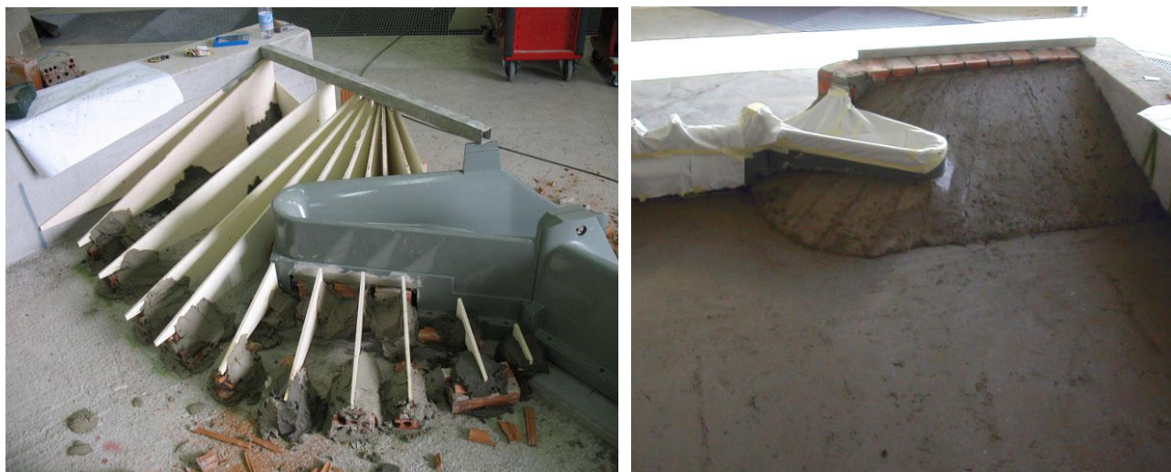
Figura B.8 – Realizzazione degli argini.
