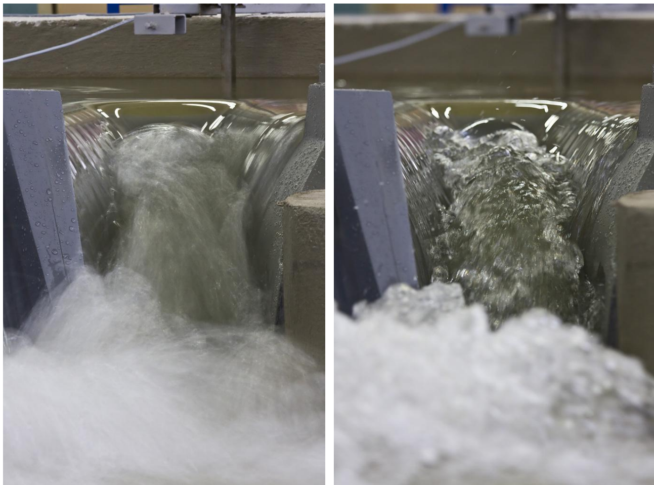
Figura F.15 – Particolare becco d’anatra in sponda sx con portata millenaria.
