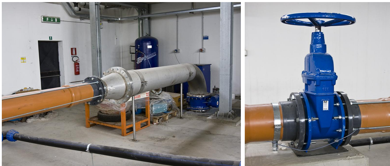
Figura B.10 – Allaccio del circuito idraulico del modello a quello del laboratorio e saracinesca di regolazione.
