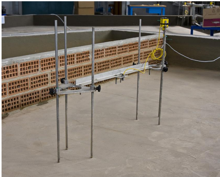
Figura 2.5 –Trasduttore di livello di monte e di valle.
