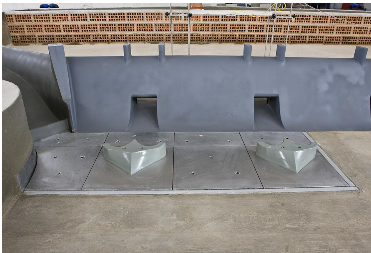
Figura F.6 – Zona di misura della vasca di dissipazione vista da valle.
