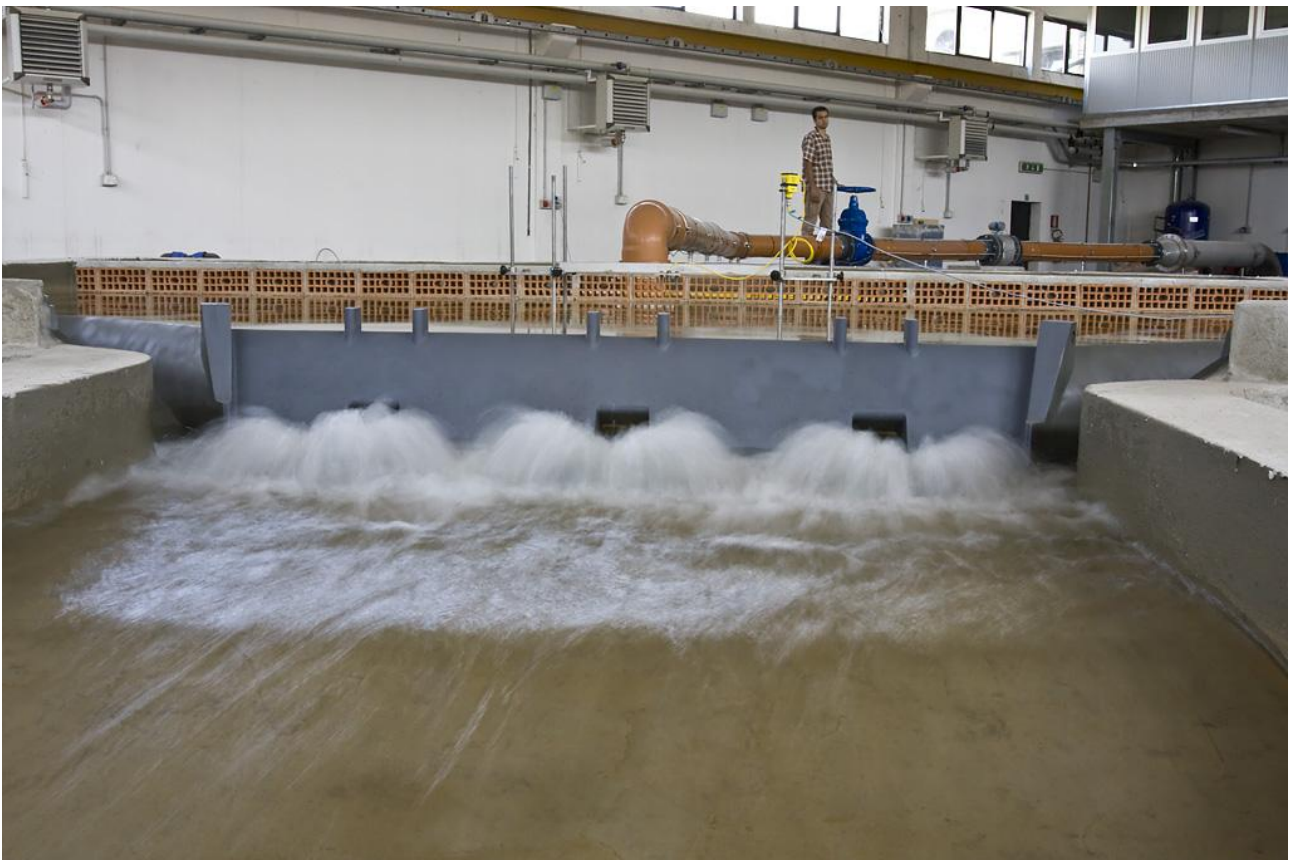
Figura F.10 – Modello visto da valle con portata uscente dalle luci di fondo.
