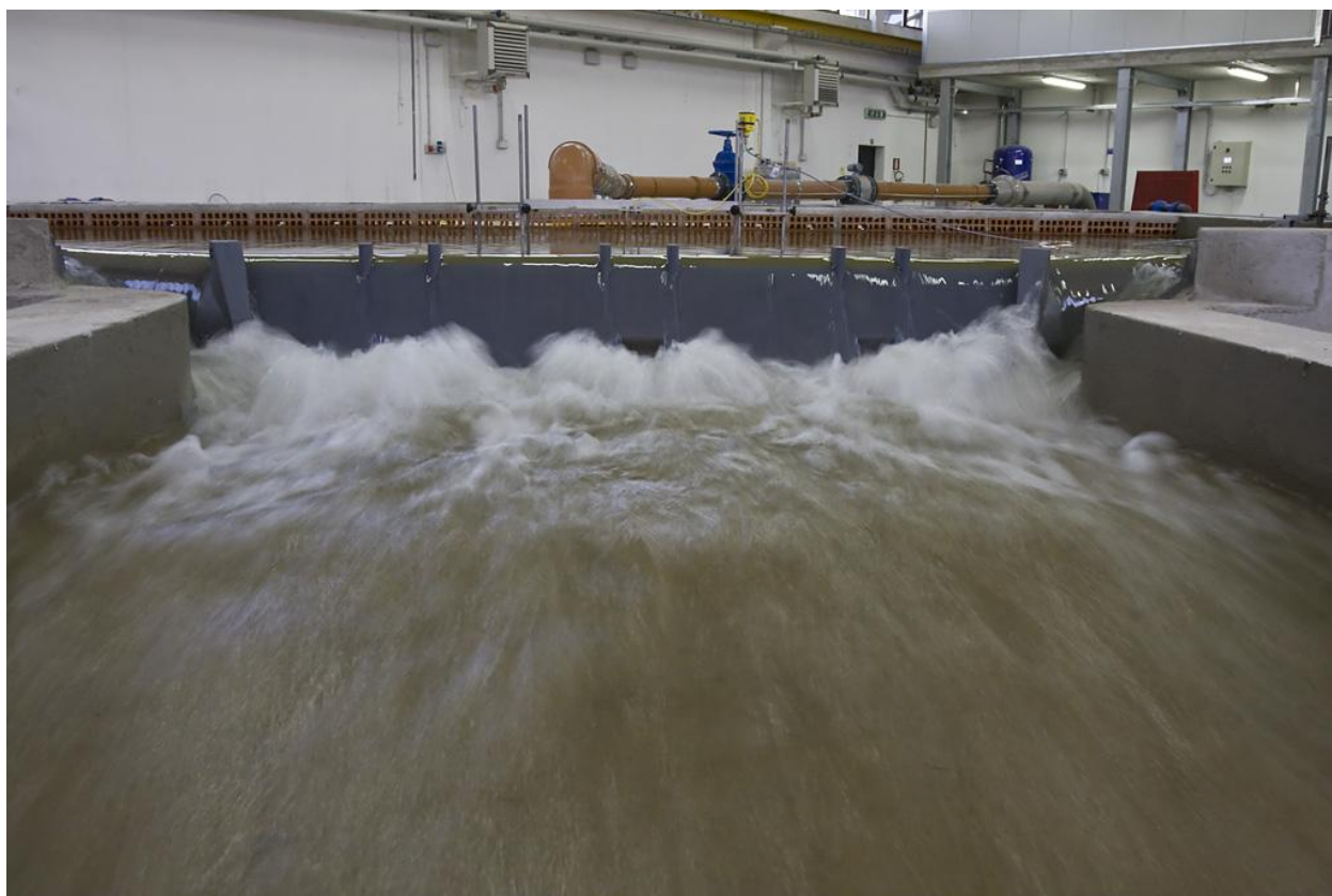
Figura F.14 – Portata millenaria evacuata dalle luci di fondo e dallo sfioratore di superficie.
