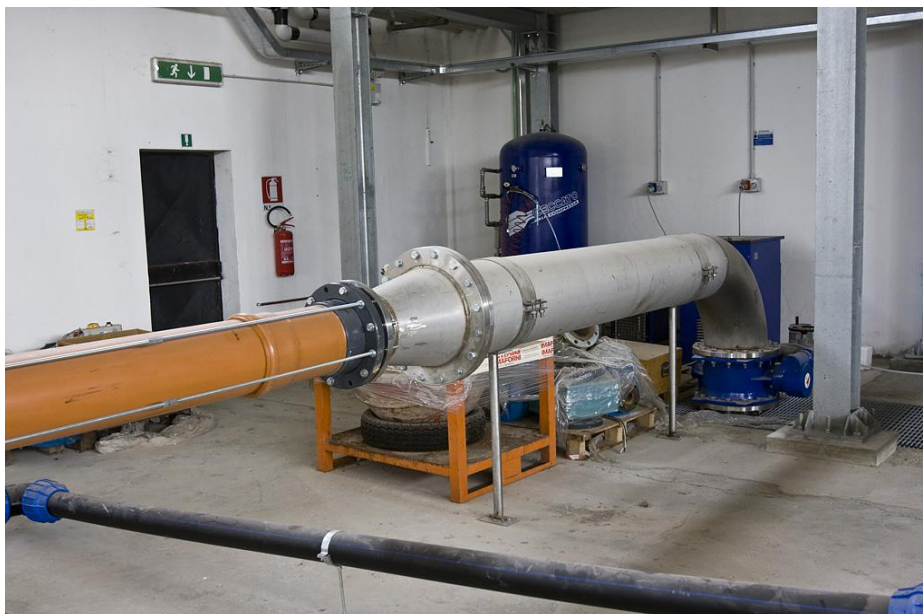
Figura 2.3 – Condotta di alimentazione del modello fisico.
