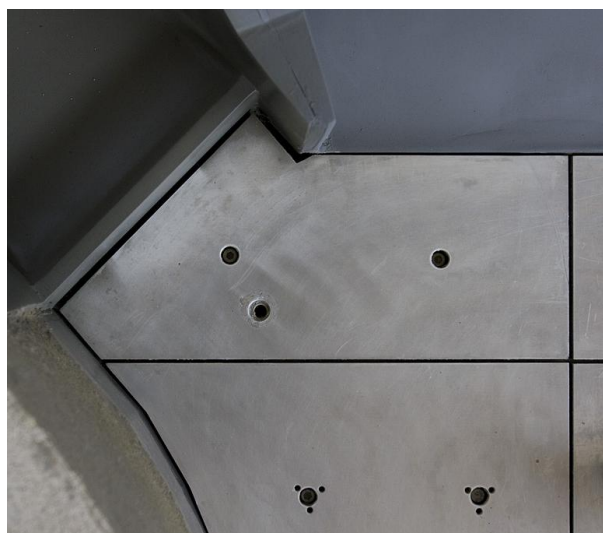
Figura F.8 – Particolare presa celle di pressione piastre 1 e 8.
