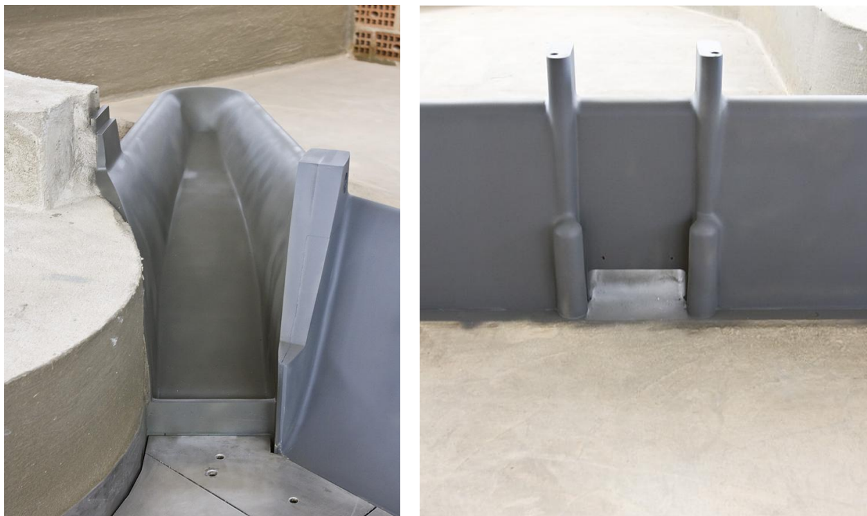
Figura F.5 – Particolare becco d’anatra visto da valle e bocca di uscita vista da monte.
