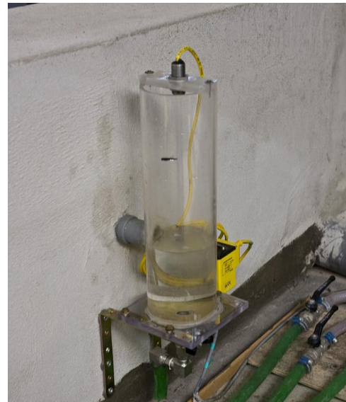
Figura 2.5 –Trasduttore di livello di monte e di valle.
