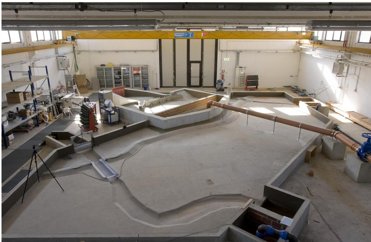
Figura F.1 – Posizionamento modello fisico all'interno del laboratorio di Idraulica n.1.
