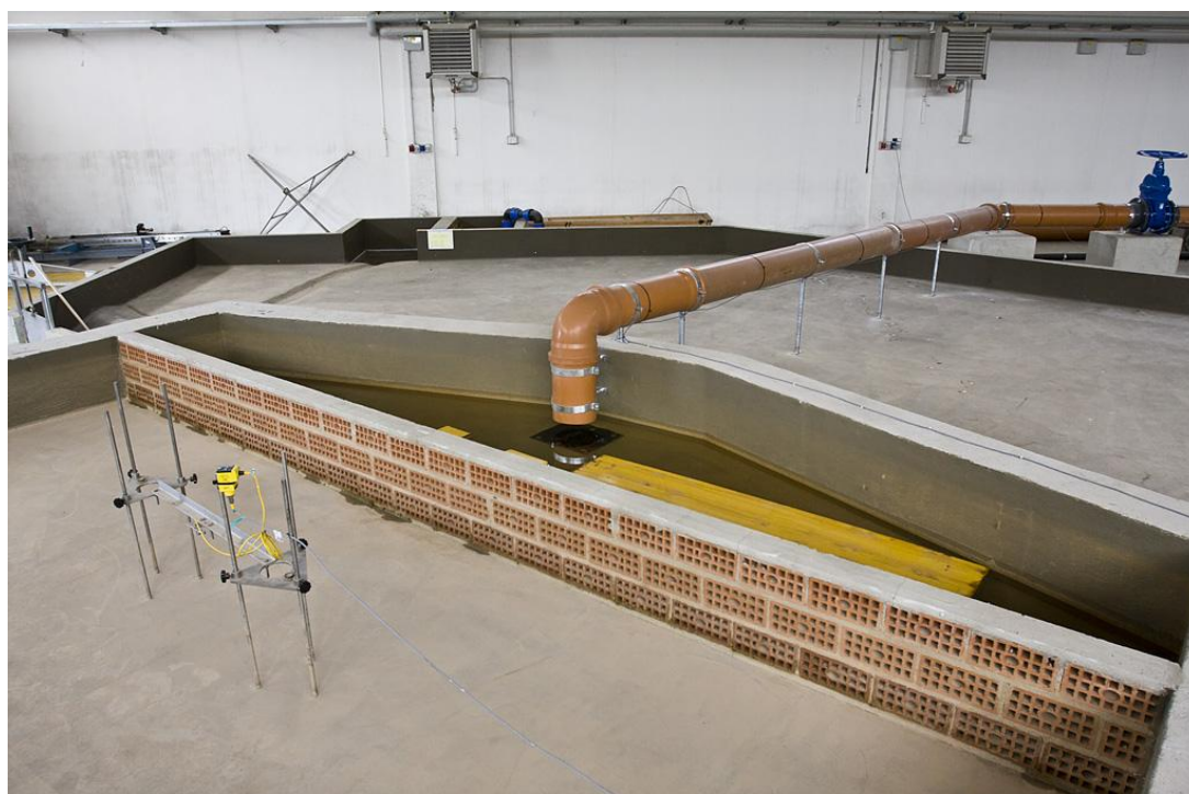
Figura B.11 – Curva di ingresso al modello e muro in mattoni con fori orizzontali.
