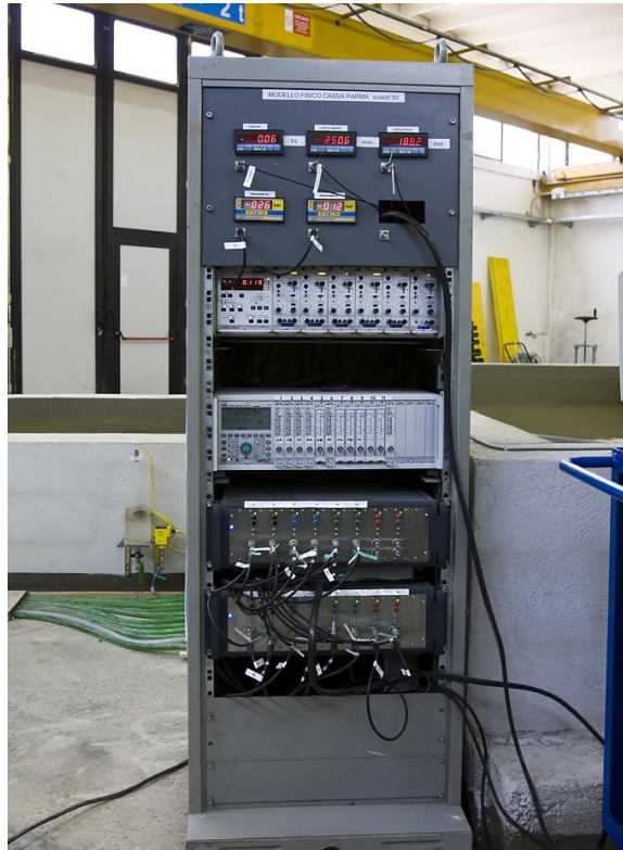
Figura F.9 – Elettronica di condizionamento dei segnali acquisiti.
