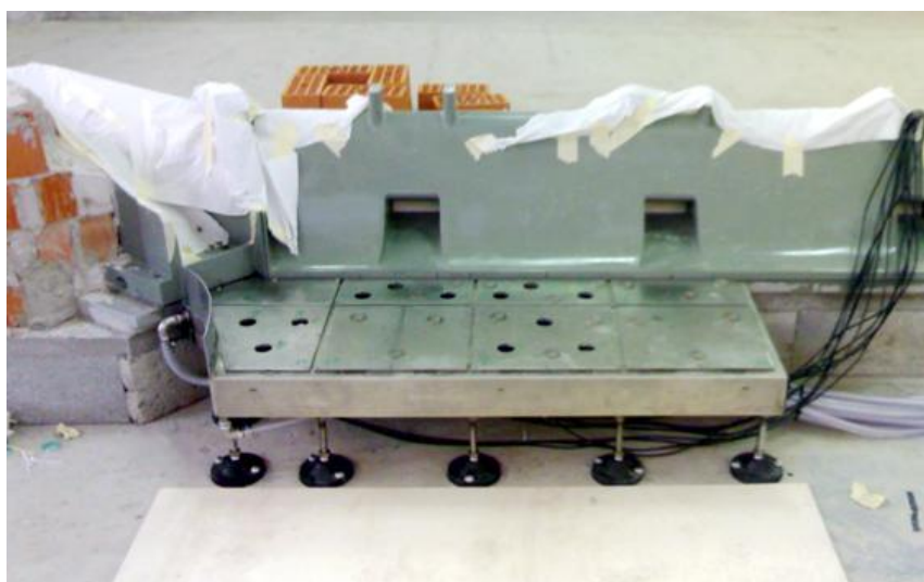
Figura B.2 – Traliccio in acciaio inox contenete la strumentazione.
