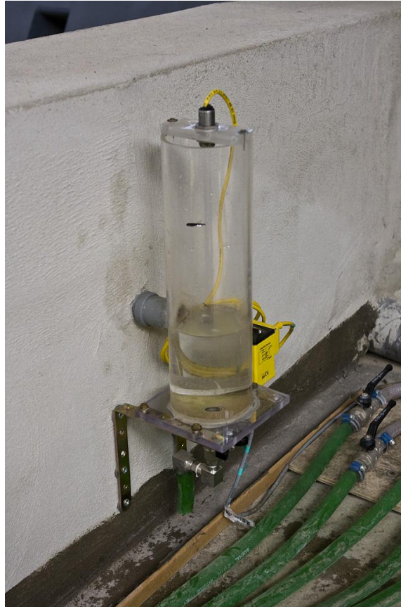
Figura B.12 – Pozzetto di calma per la lettura del livello a valle della vasca di dissipazione.
