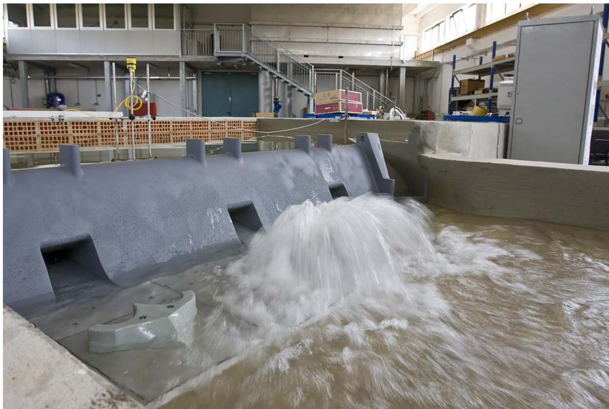
Figura F.11 – Modello visto lateralmente con portata uscente dalla sola luce centrale.
