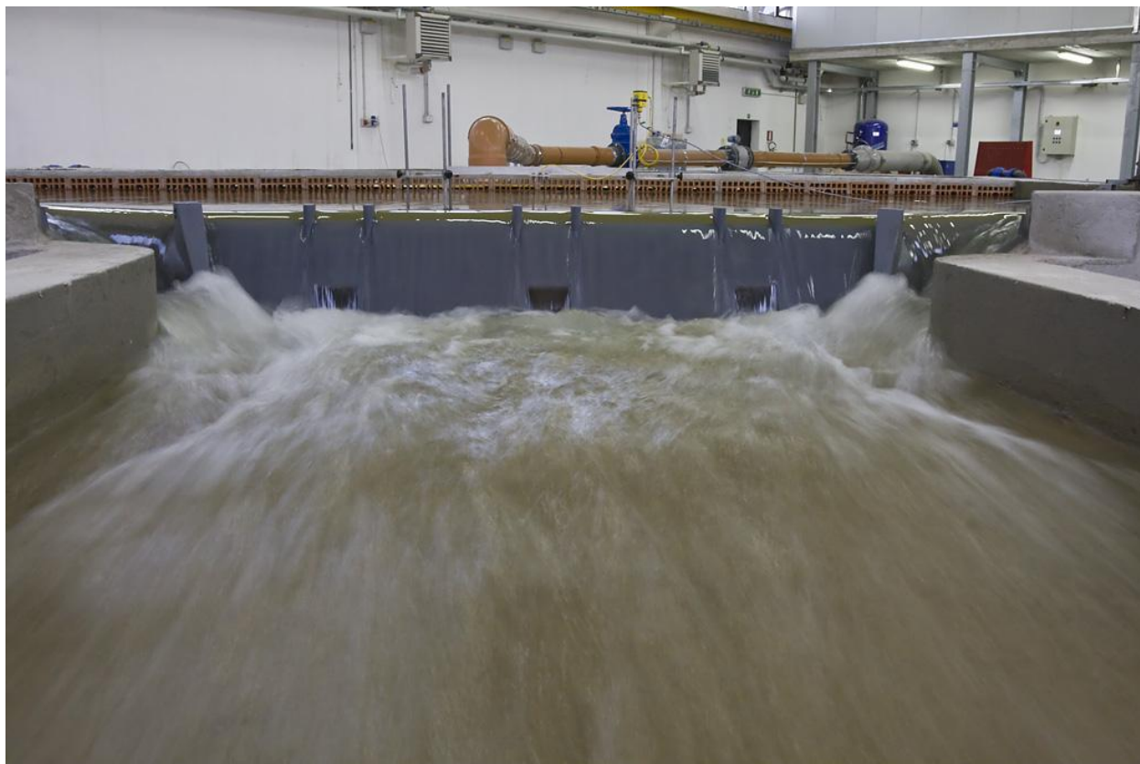
Figura F.13 – Portata millenaria evacuata tutta dallo sfioratore di superficie.
